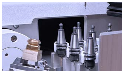
Standard-Werkzeugmagazin ISO10 mit neun Plätzen
