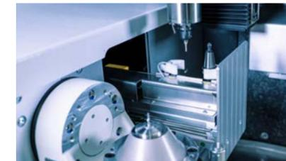
Werkzeugwechselsystem bei großem Werkzeugspeicher
