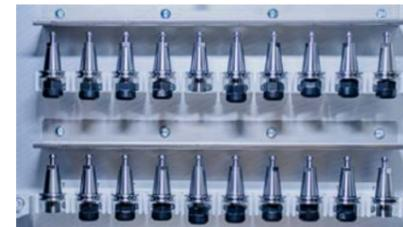
Der erweiterte Werkzeugspeicher nimmt bis zu 40 Werkzeuge ohne zusätzlichen Flächenbedarf auf. Über das Schubladensystem werden Alt- und Neuwerkzeuge ausgetauscht. Der Zugang ist über die seitliche Türe auch während des Betriebes möglich.
