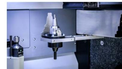
Für die Vermessung der Werkzeuglängen ist direkt an der C-Achse ein Messtaster möglichst nahe vor Ort. Bei der Direktspannung wird jedes Mal nach einem Werkzeugwechsel die Länge gemessen, während bei der Verwendung der SBN-Aufnahmen darauf verzichtet werden kann.
