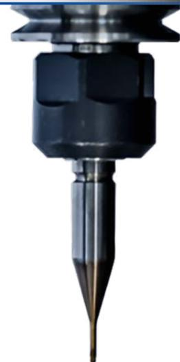
Bei allen Varianten der Werkzeugaufnahmen werden die Werkzeuge immer auf der Hauptachse mitgeführt und möglichst nahe am Arbeitstisch gewechselt. Hierbei sind die kurzen Wege und die Längenmessung direkt am Arbeitstisch von großem Vorteil.
