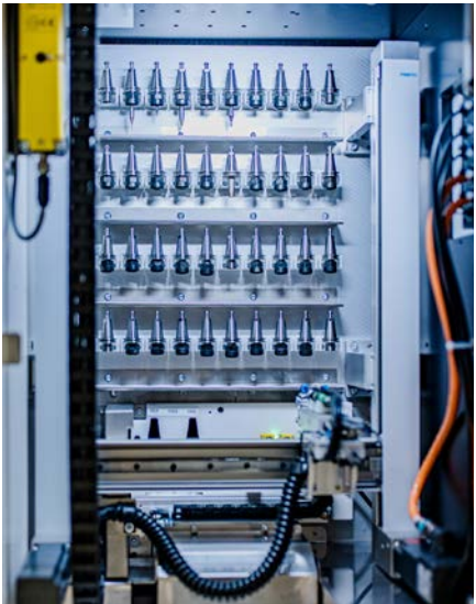
Système de changement d'outils avec grand magasin d'outils
