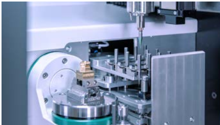
Magasin d'outils standard Serrage direct à douze emplacements
