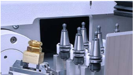
Magasin d'outils standard SBN10 avec six places
