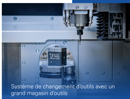
Magasin d'outils standard, ISO10 avec 6 emplacements
